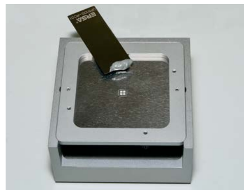
Dip & Print Station mit "MLF32" Schablone
